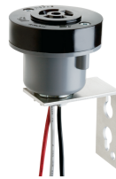
K122 Prise à verrouillage, 3 broches, conforme à la norme C136.10, avec support pour montage sur poteau
